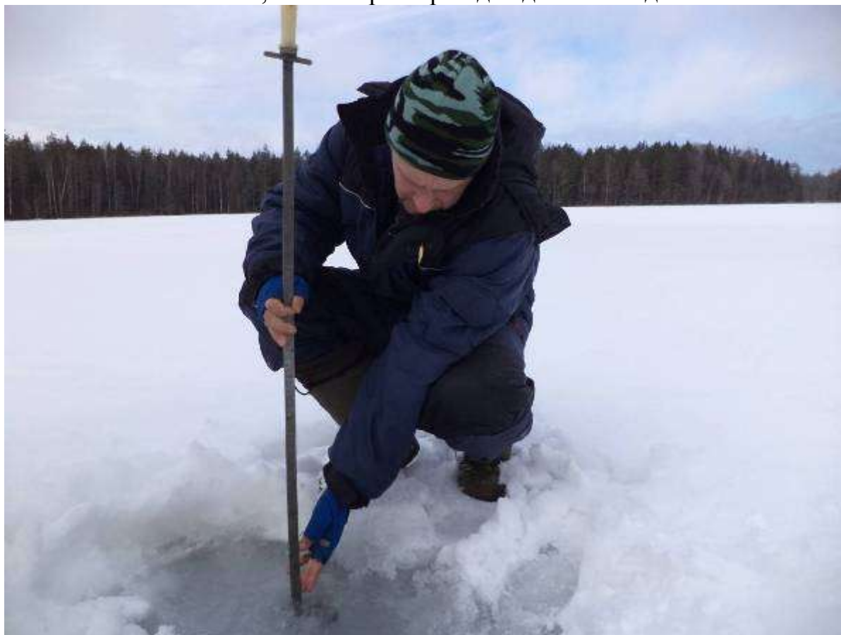
Рисунок 6.2.3 Измерение толщины льда, оз. Мутное.
