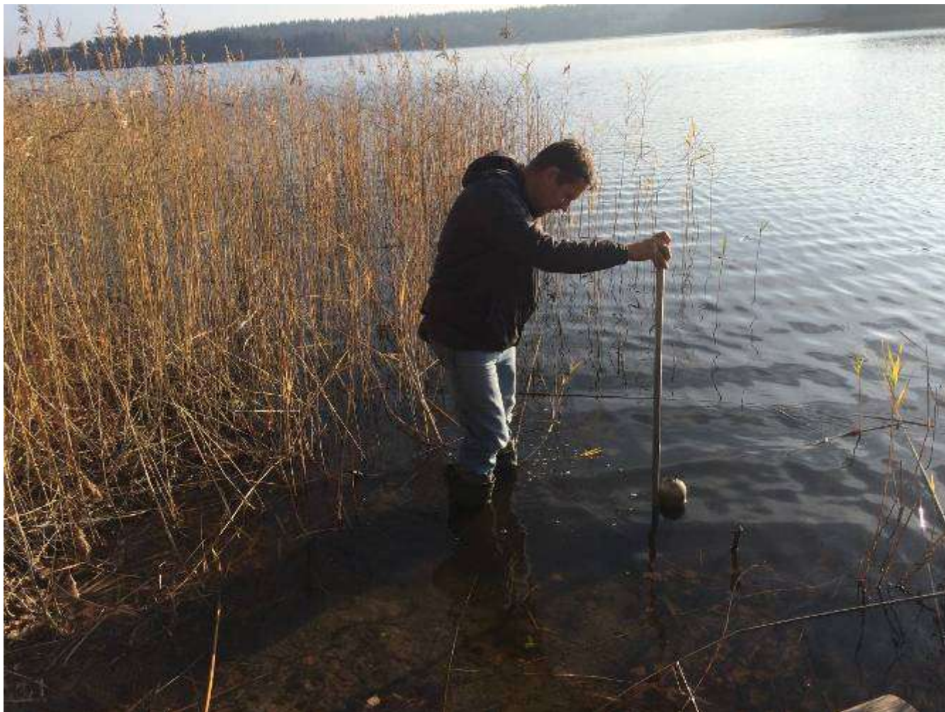
Рисунок 6.1.1. Измерение уровня на водомерном посту оз. Сапшо.
